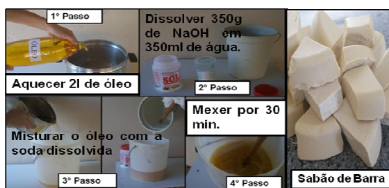
Figura 1 - Representação dos passos para a produção do sabão caseiro de barra partindo do óleo de fritura e soda cáustica.
