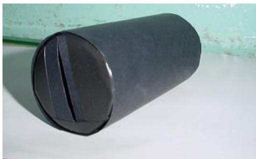
Figura 3: Espectroscópio caseiro simples, conforme Brockington (2005)
