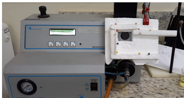
Figura 1. Fotografia do suporte confeccionado para apoiar o aparelho celular durante as medições fotométricas
