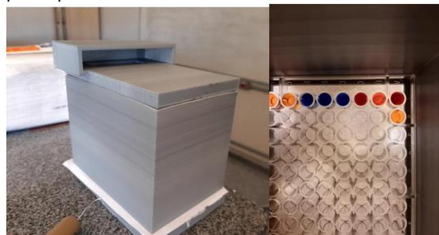
Figura 2. Dispositivo de obtenção de imagens (a) protótipo impresso; (b) imagens obtidas de soluções básicas (amarelo), neutras (azul) e ácidas (vermelha).
