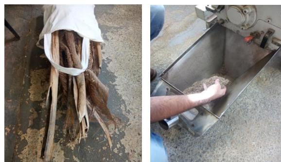
Figura 1. Cascas de gueroba (esquerda) / Cascas trituradas (direita) no triturador de madeira RTL Lippel
