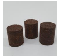
Figura 2 - Pellet Compactado. Fonte: Própria.
