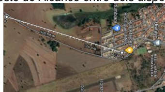
Figura 2. Teste de Alcance entre dois dispositivos LoRa
