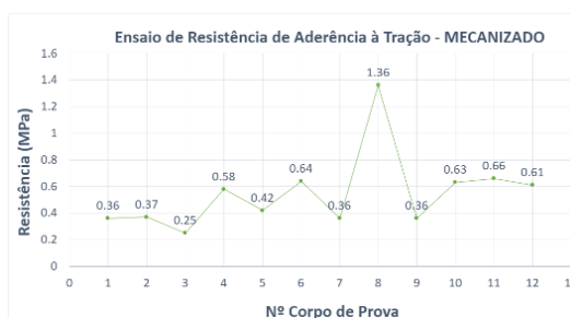
Figura 3. Gráfico referente aos valores de cada corpo de prova ensaiado do reboco mecanizado. Fonte: Autor
