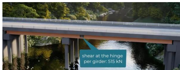
Figura 4. Resultado de Esforço Interno de Cisalhamento Máximo – Dr. Lakmazaheri.
