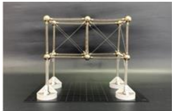
Figura 2. Treliça representada por meio do Kit Estrutural Mola®.
