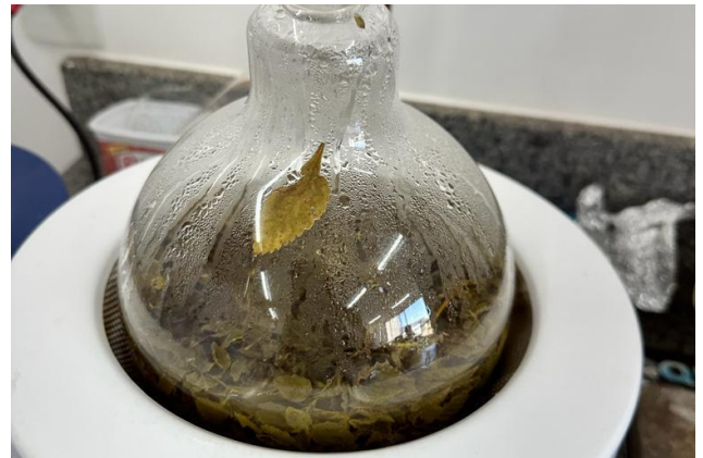
Figura 1. Extração do óleo essencial de Mesosphaerum suaveolens feito na UEG - Câmpus Anápolis
