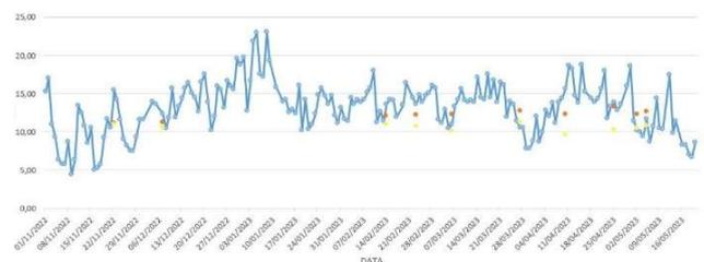
**Figura 4. Variação da UEM (eixo vertical). Método de Simpson em azul, Madeira Cambará pelo método Gravimétrico em vermelho, e Madeira Itaúba pelo método Gravimétrico em amarelo.**
