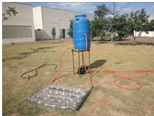
Figura 1. Aquecedor em funcionamento.
