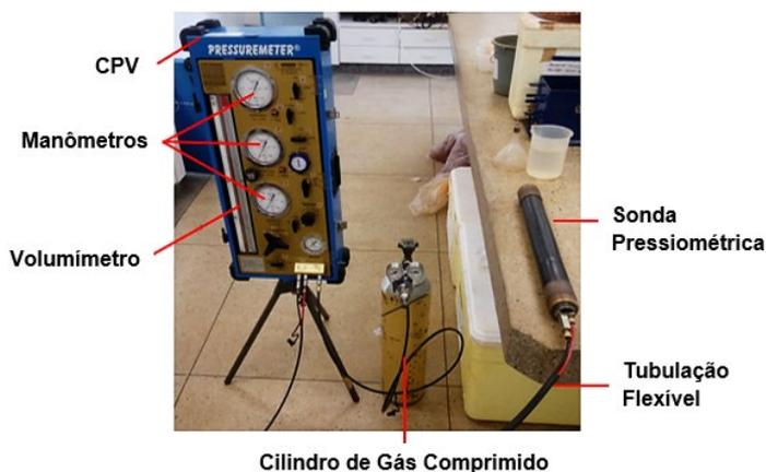
Figura 1 – Vista geral do pressiômetro Ménard
