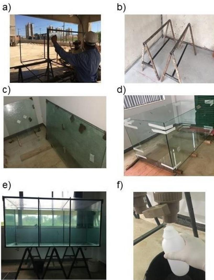
**Figura 3 - Construção do reservatório (modelo físico): a) montagem da armadura de reforço; b) cavaletes de suspensão do reservatório; c) peças de vidro temperado 10 mm; d) estrutura de vidro montada com silicone industrial; e) vista lateral do reservatório e f) coleta da amostra.**
