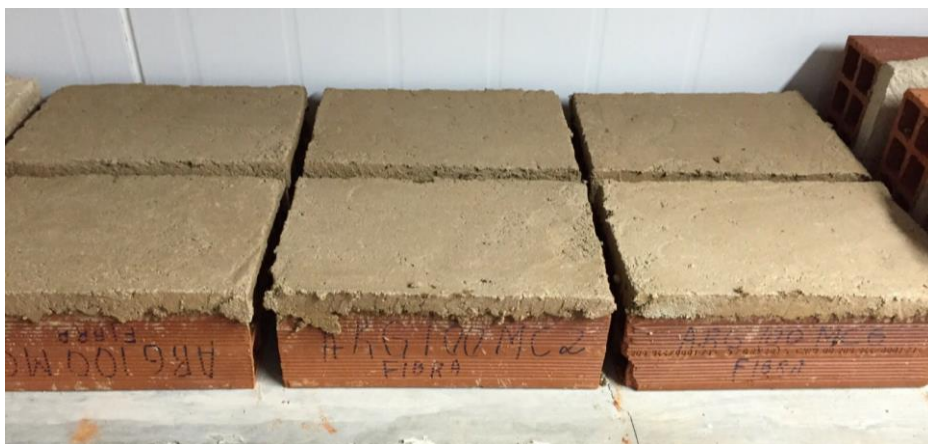
Figura 1 – Aplicação da argamassa
