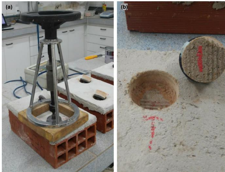
Figura 2 – Determinação da resistência de aderência à tração: (a) realização do ensaio; (b) CP após teste.
