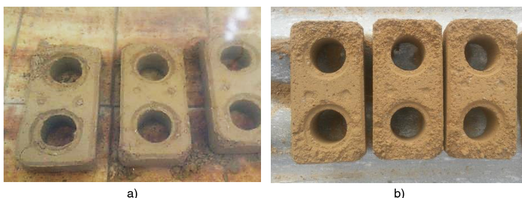
Figura 6 - TSC produzido e testado com aspectos de fragmentação após escovação mecânica: (a) antes e (b) após a exposição natural
