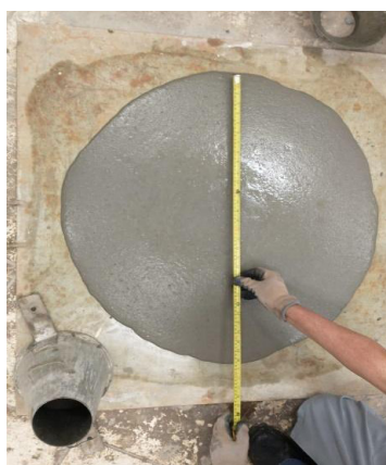
Figura 2 – Teste de espalhamento do microconcreto
