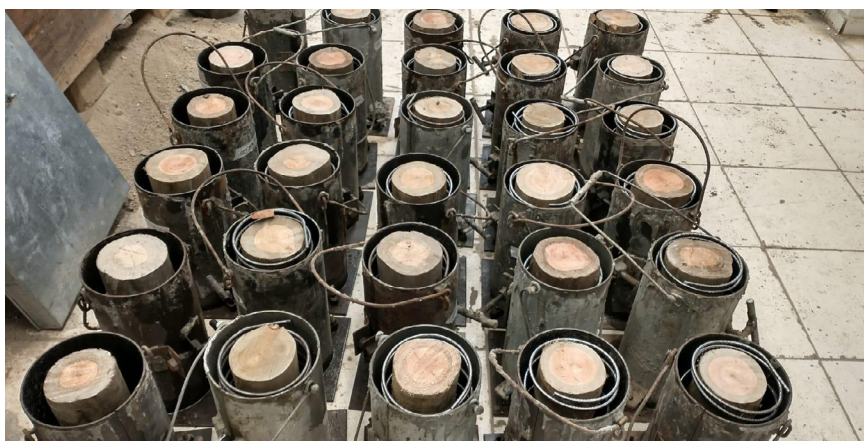
Figura 4 – Conjunto de CPs concretados na base de 2 cm
