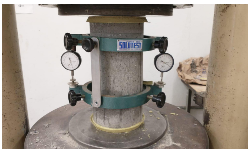
Figura 5 – CP com aparelhagem para deformação
