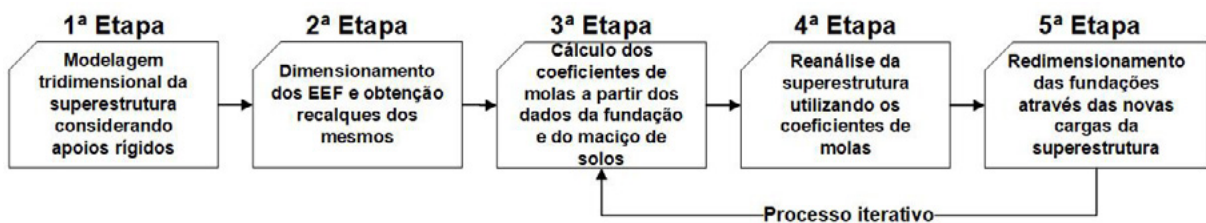
Figura 14 – Fluxograma do procedimento de cálculo e análise considerando a ISE
