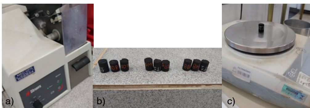
Figura 4 – (a) Serra de corte, (b) CPs cortados, (c) Pesagem CP cortado
