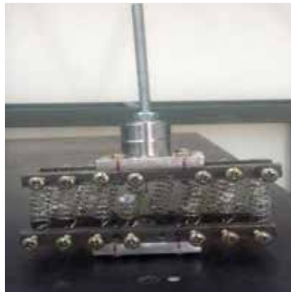
Figura 5 Neutralizador dinâmico de vibrações construído. Fonte: O autor (2016).
