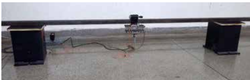
Figura 6 Acoplamento viga-motor-neutralizador. Fonte: O autor (2016)
