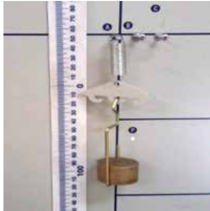
Figura 4 Ensaio estático das molas. Fonte: O autor (2016).
