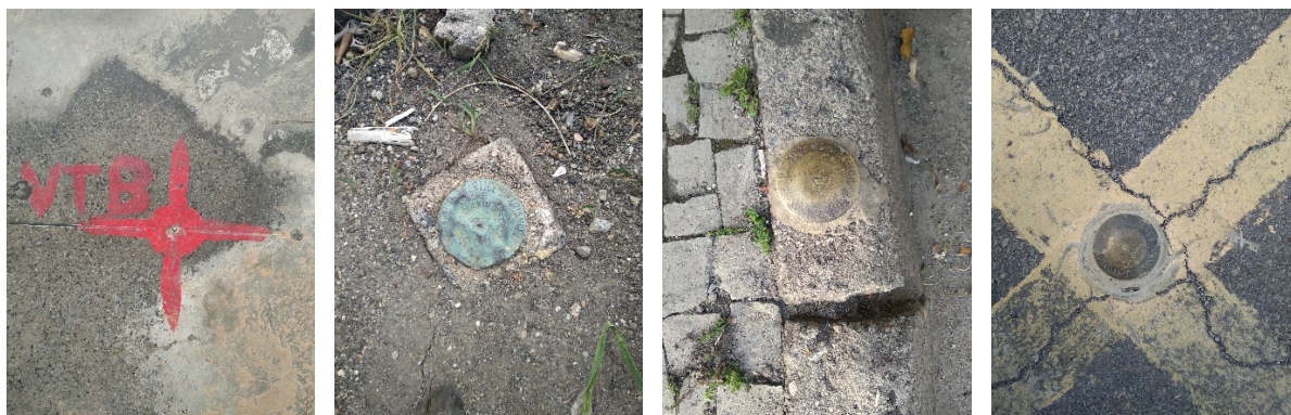
Figura 8 – Vértices pertencentes a rede planialtimétrica do artigo (VTB, P4, P3 e P9)
