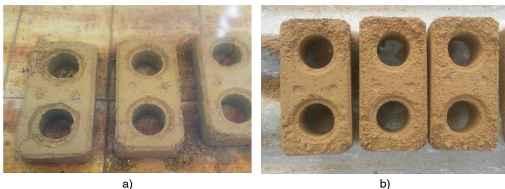
Figura 6 - TSC produzido e testado com aspectos de fragmentação após escovação mecânica: (a) antes e (b) após a exposição natural
