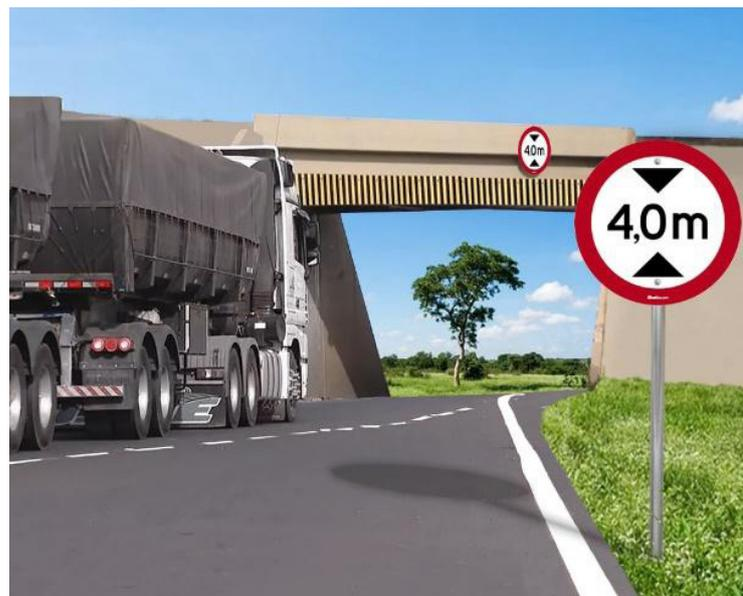
Figura 31 - Simulação de implantação de Placa R-15 – Altura máxima permitida
