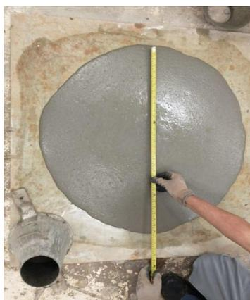
**Figura 2 – Teste de espalhamento do microconcreto**
