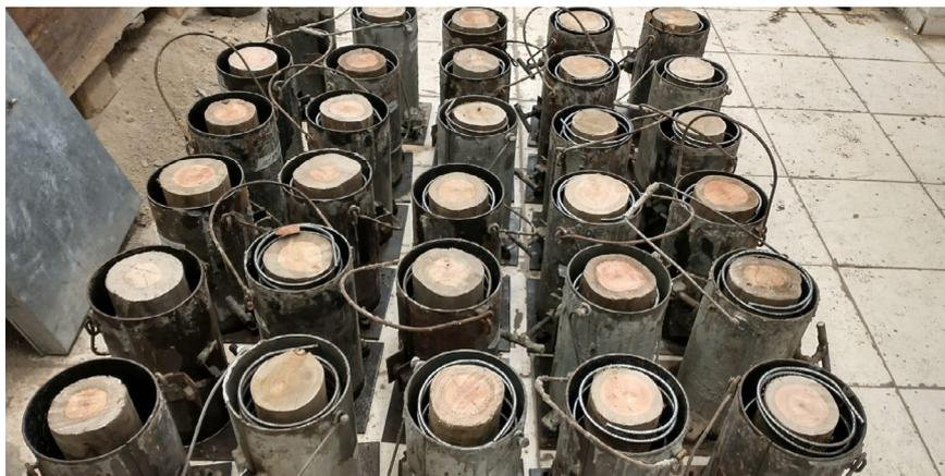
**Figura 4 – Conjunto de CPs concretados na base de 2 cm**
