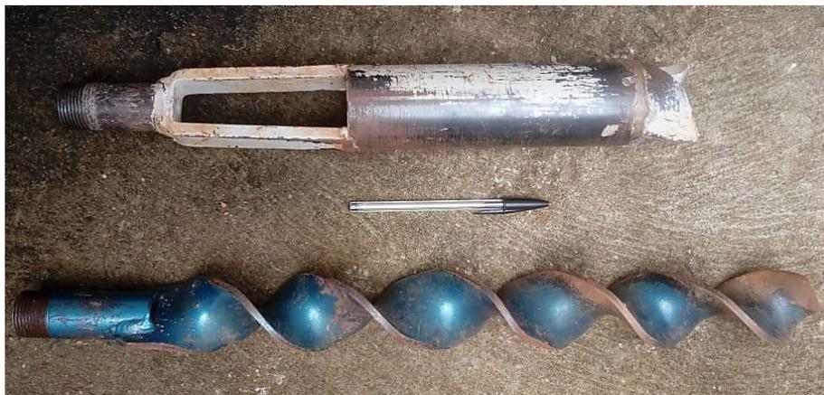
**Figura 5 – Trados do tipo copo e helicoidal utilizados para realização dos pré-furos**
