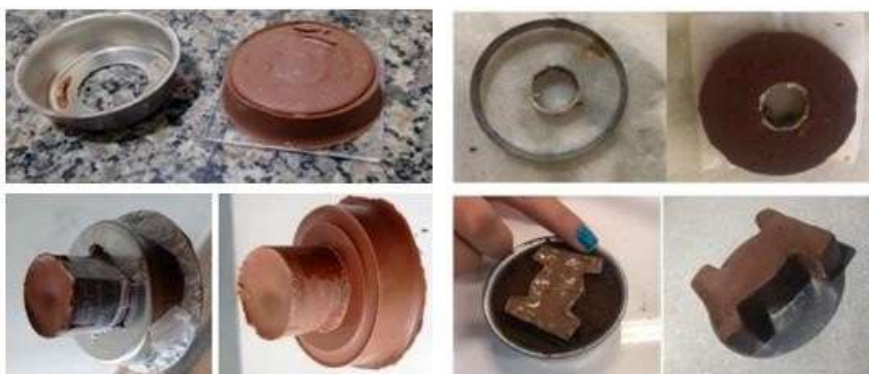
Figura 4 – Peças solidificadas após resfriamento, seguido de desmoldagem
