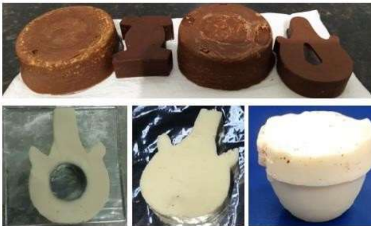
Figura 5 – Exemplos de peças fabricadas pelos estudantes na simulação do processo de fundição
